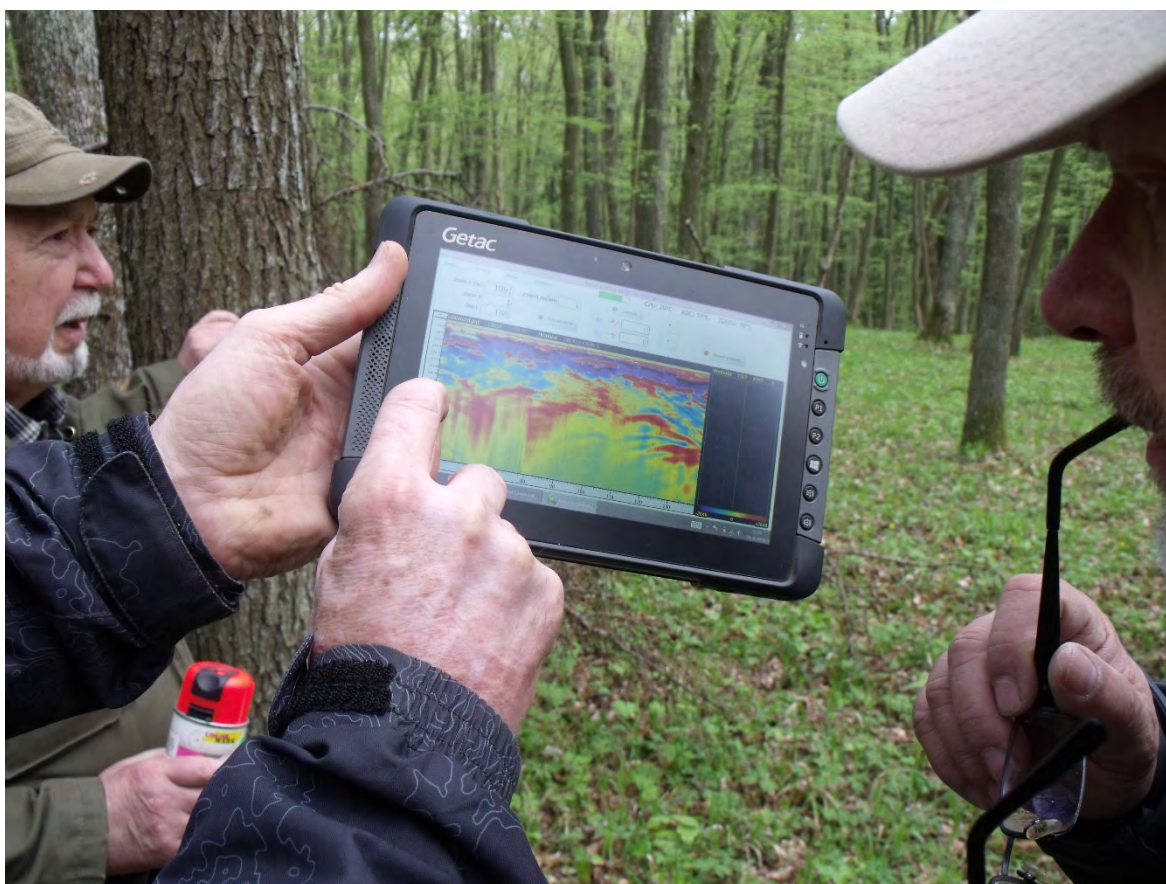
Obr. nahoře : Odraz geologických vrstev na monitoru georadaru.
