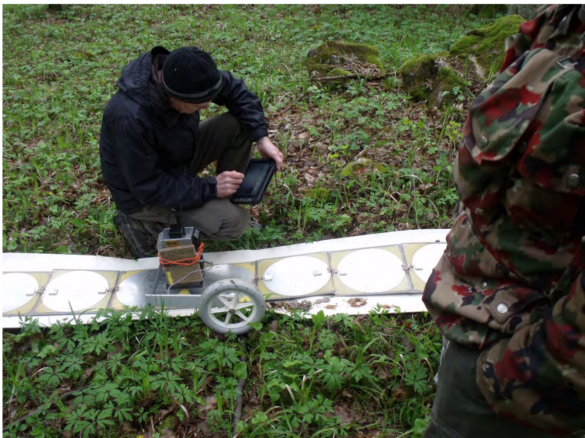
Na snímku dole vidíme zřetelně elektrody antény a jejich propojení na plastovém pásu.
