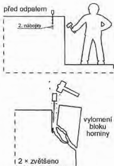
Obr. 7. Postup výlomu nastřelovacími nábojkami.
