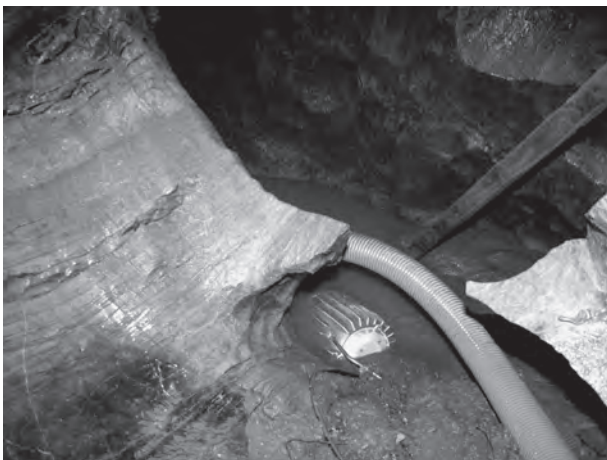
Obr. 2: Hroch (SIGMA GFHU 100-250) po sčerpání hladiny o 19 metrů. Foto: J. Slonek, IX. 2005.
