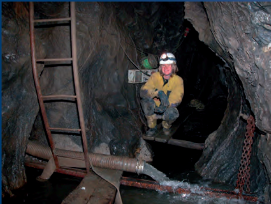
Výtlak vody čerpané kaskádou čerpadel SIGMA z přítokového sifonu ve Starém Lopači; A. Balabánová na plošině nad odtokovým sifonem. Foto: J. Slonek, IX. 2005.
