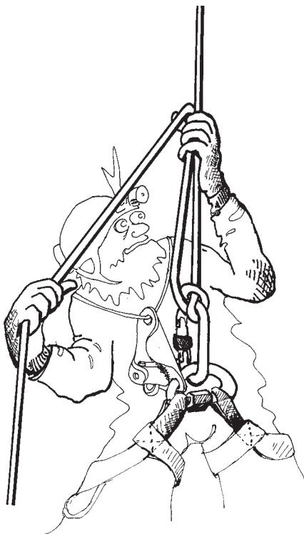
Obr. 8: Poloviční lodní smyčka – slanění.
