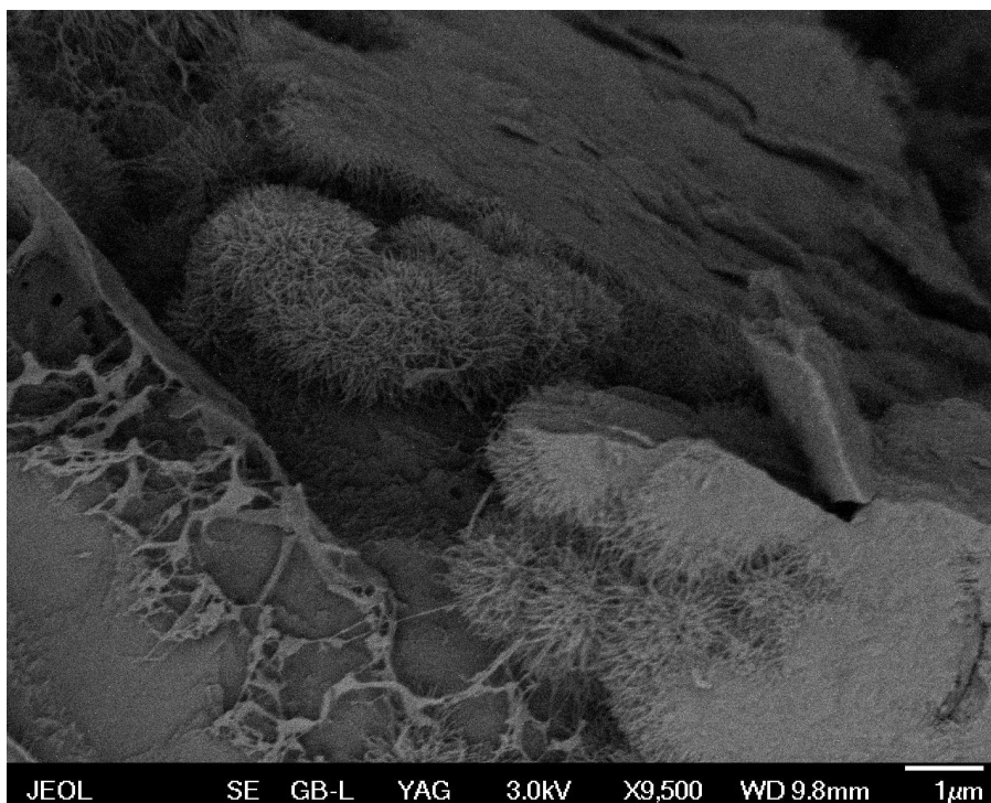
Obrázek 1: Schwertmannit v skenovacím elektronovém mikroskopu. Tyto ježaté kuličky jsou ideální materiál pro barvení kůží a syntézu nanočástic železa.
