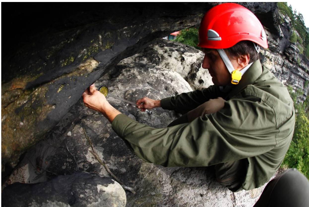
Obr. 2: Skalník při dilatometrickém měření na Pravčické bráně
