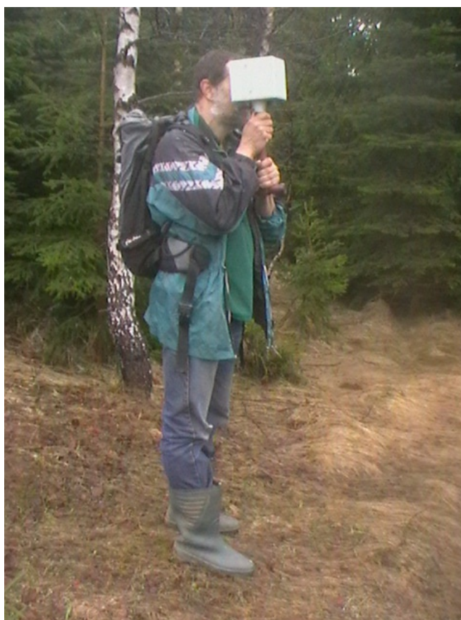
Foto 1 Měření elektromagnetického pole na frekvencích VDV
