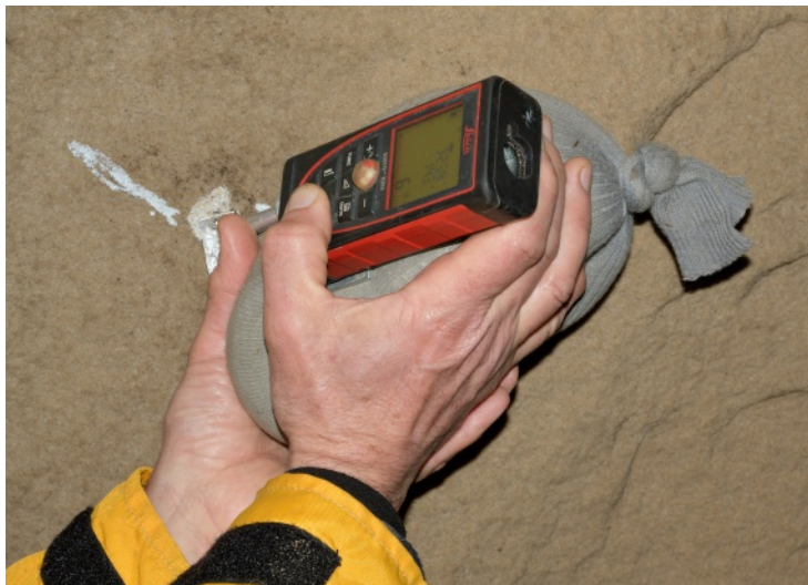
Obr. 11 Rýžový stativ dodá stabilitu (Foto: J. Moravec)
