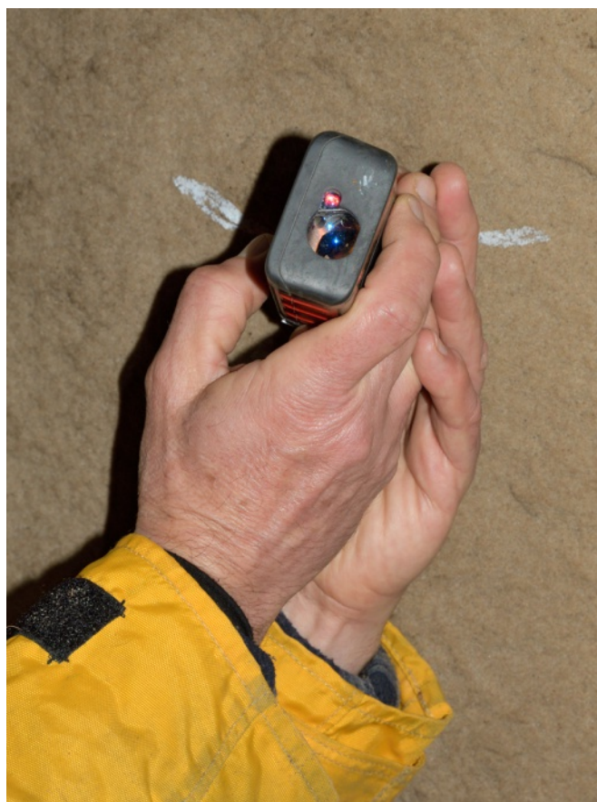
Obr. 9 a 10 Kolmý směr, ruka se nemá o co opřít, Disto se chvěje. (Foto: J. Moravec)
