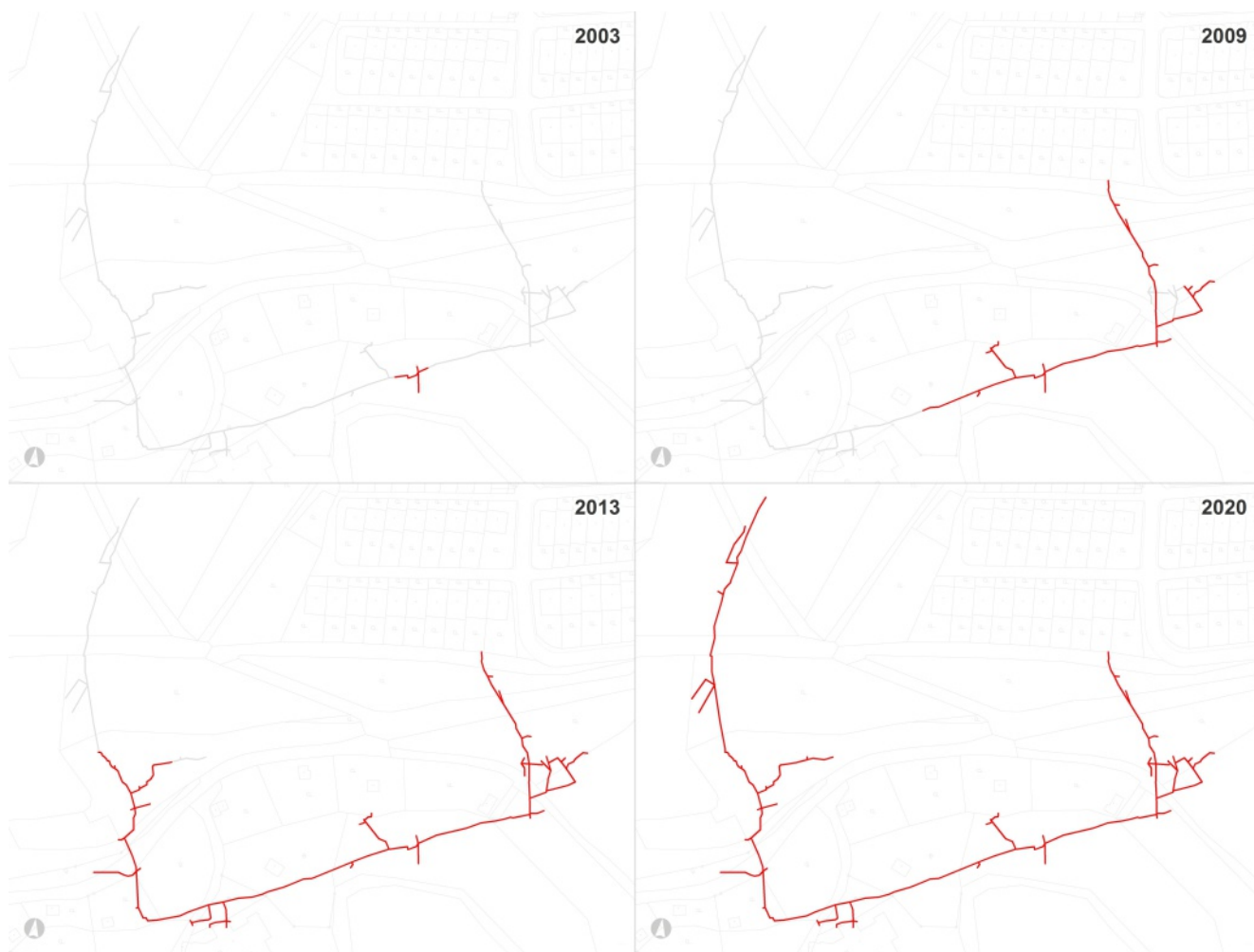
Obr. 3 Postup zmáhacích prací na díle Bylanka IV. P. Brzák, P. Zeman, J. Kavalír, O. Malina.
