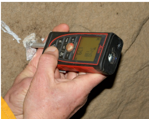
Obr. 9 a 10 Kolmý směr, ruka se nemá o co opřít, Disto se chvěje. (Foto: J. Moravec)
