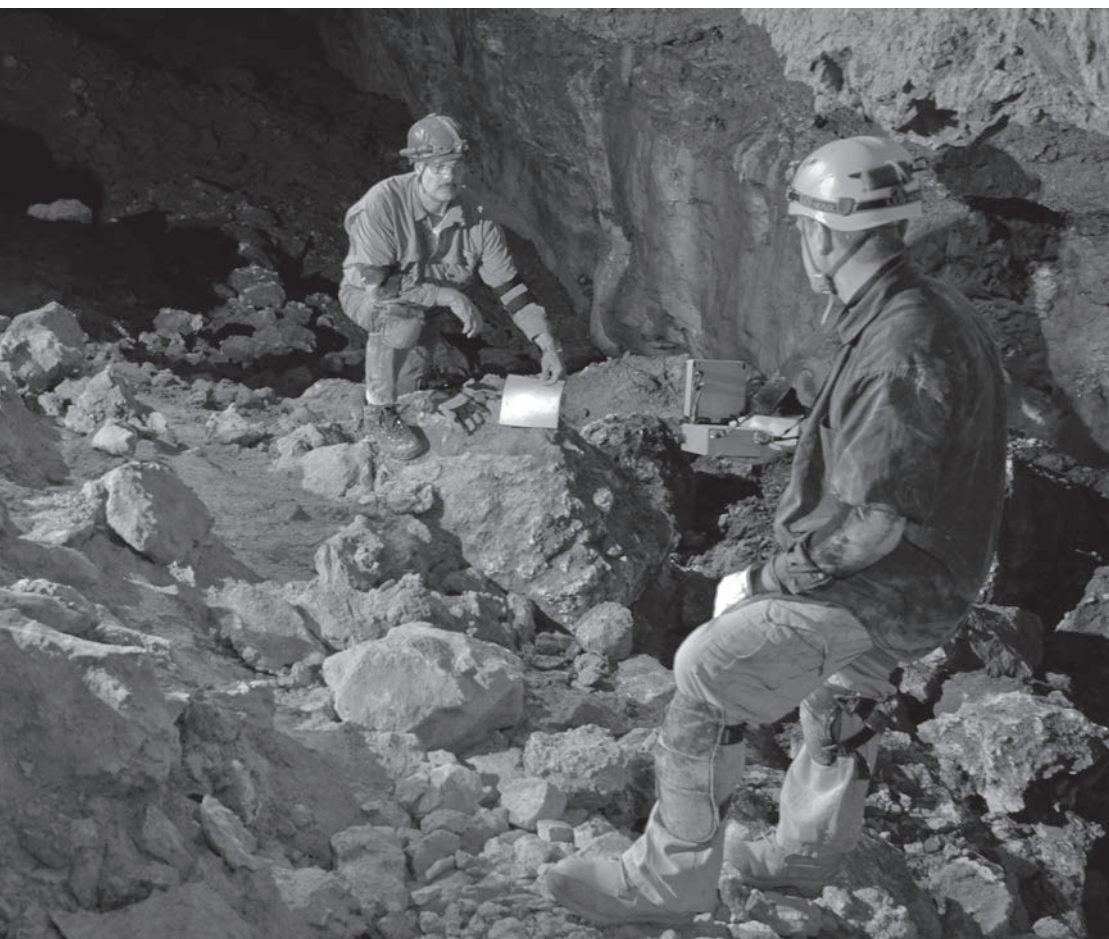
Obr. 2 Ukázka měření s Caveatronem (zdroj www.caveatron.com )
