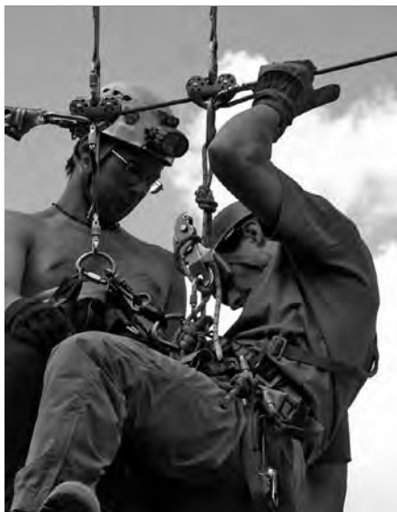
Obr. 3 Zajištění kladek proti pohybu a propojení centrálních karabin.
