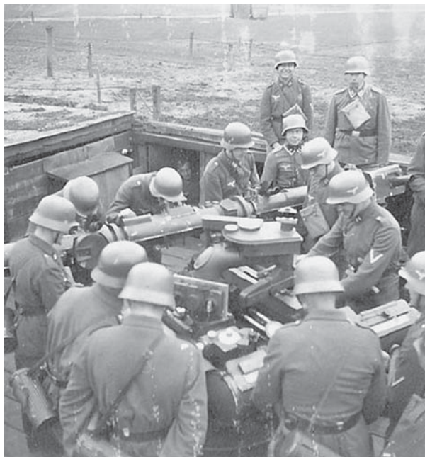
Obr. 3: Kommandogerät 40, zaměřovací a povelový přístroj s výpočtem předstihu obsluhovalo 5 mužů a velitel. Zařízení vybavené analogovým počítačím strojem řídilo palbu baterií flaku na cíl. Foto – sbírka autora.
