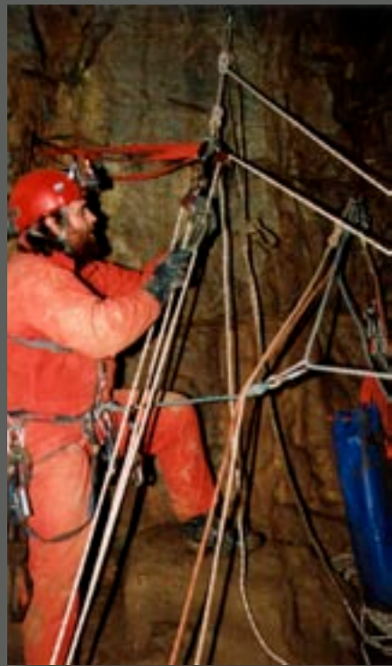
Instalace vyprošřovacího kladkostroje
