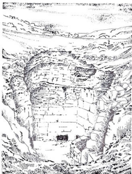
Rekonstrukce těžební jámy na pazourek v Cissbury, Anglie, asi 2000 let před Kristem. Šachta o průměru 4,5 x 4,5 m je 12 m hluboká a vychází z ní krátké štolky.
