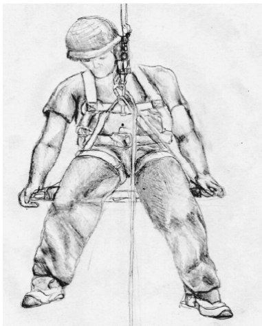
obrázek 10: Vis s použitím lavičky pro déletrvající činnost. [83]
