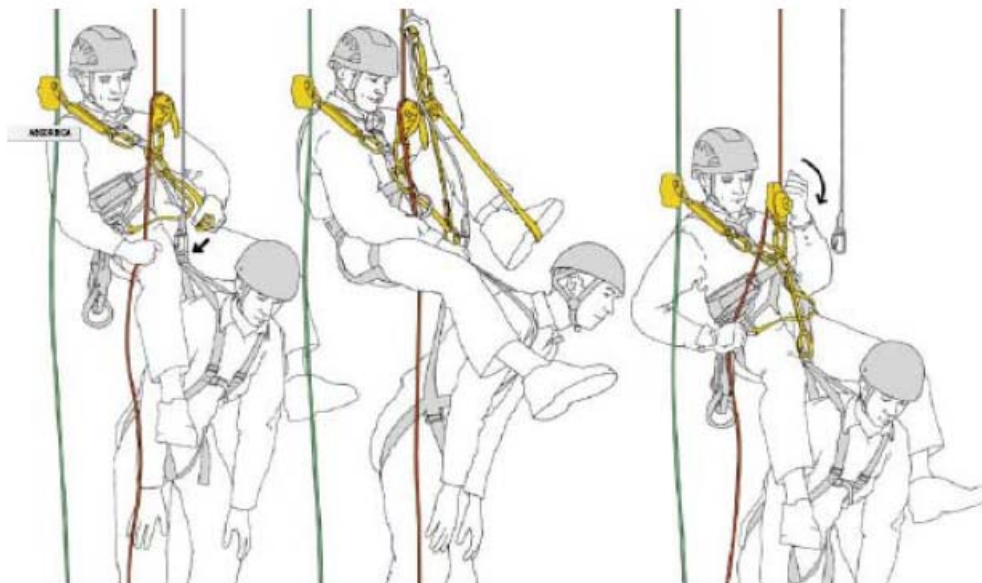
obrázek 24: Záchrana postiženého v zachycovacím postroji se zadním okem, bez přefíznutí lana. (postižený je zavěšen přímo do postroje zachránce-méně vhodný způsob) ((C) Petzl) [52]
