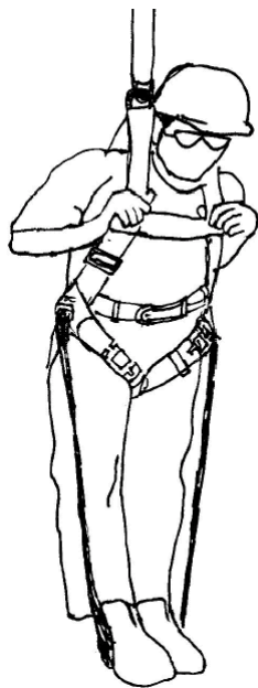
obrázek 21: Podepření nohou při visu v zadním bodě zachycovacího postroje. [83]
