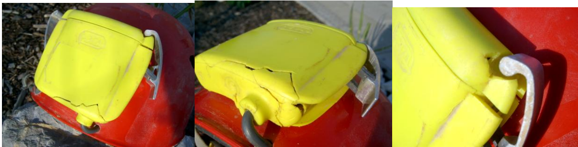
Použití zřejmě nekvalitních baterií – vytečený obsah celkem bez námahy „rozloup“ kontejner DUA na baterie na přílbě Ecrin_Petzl
