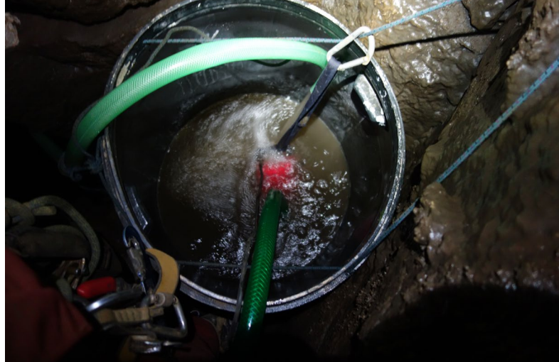
Foto 6 Nejspodnější přečerpávací stanice (foto V. Bláha)
